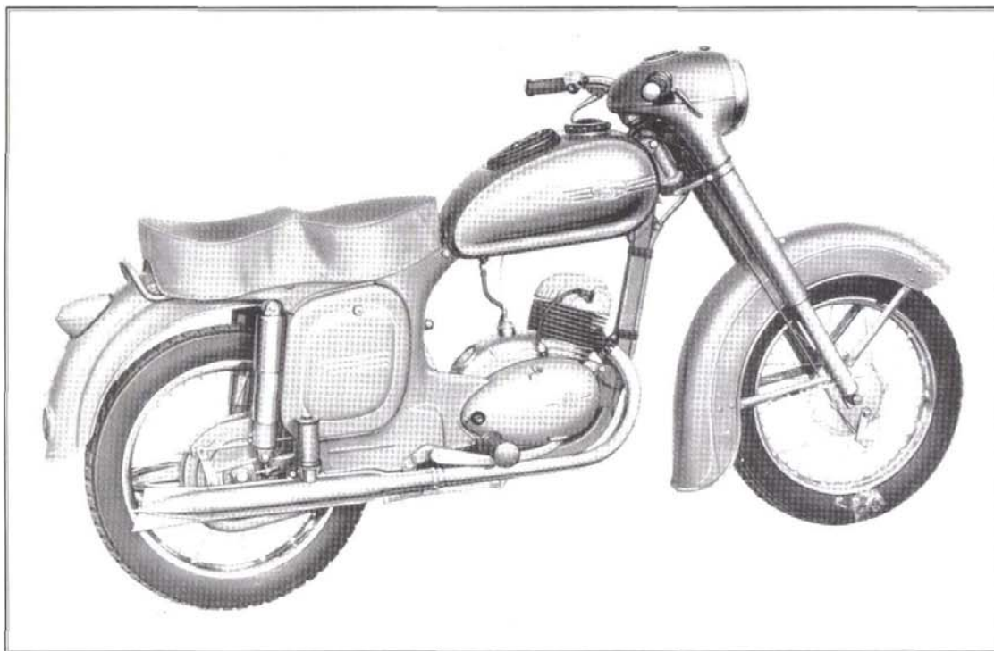
Jawa-ČZ 150 – mezityp (jednostranný brzdový buben)
