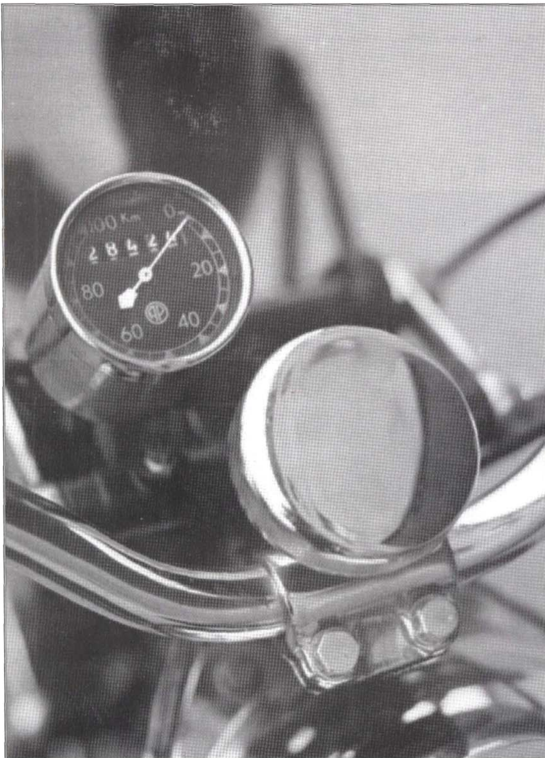
ČZ 250 – rychloměr Veigl S-WZ1 s rozsahem 0–120 km, poháněný z předního kola, byl montován pouze na objednávku
